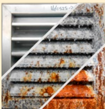
Sendzimir na 0, 500 en 1500 uur blootstelling aan zoutnevel
