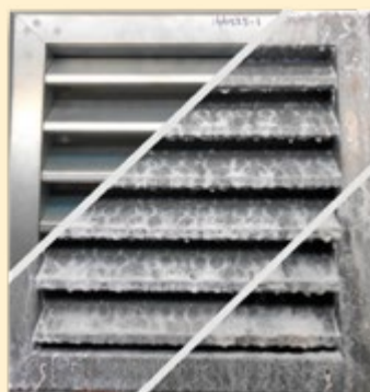
Magnelis na 0, 500 en 1500 uur blootstelling aan zoutnevel
